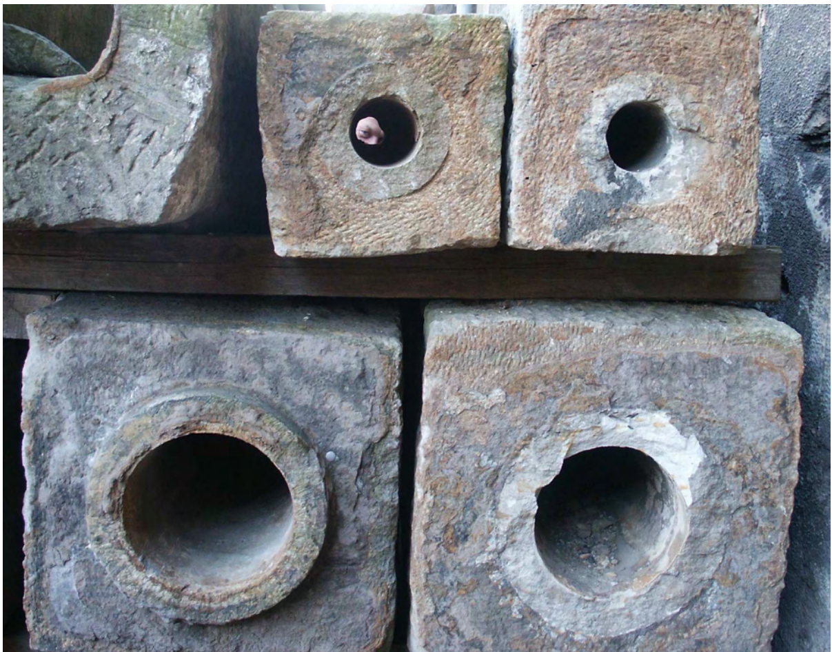
Abb. 2: Verschiedene Größen von Sandsteinröhren
