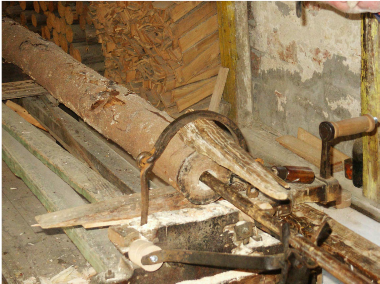
Abb. 2: Mechanisches Röhrenbohrwerk in Friedebach/Sayda(Erzgebirge)
