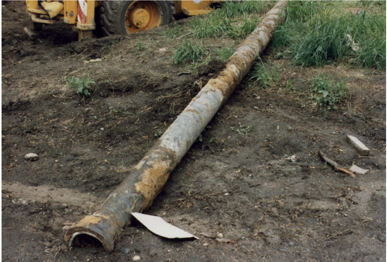
Abb. 2: Gusseiserne Röhrfahrt der Oberfischmannsteichleitung im 20. Jahrhundert
