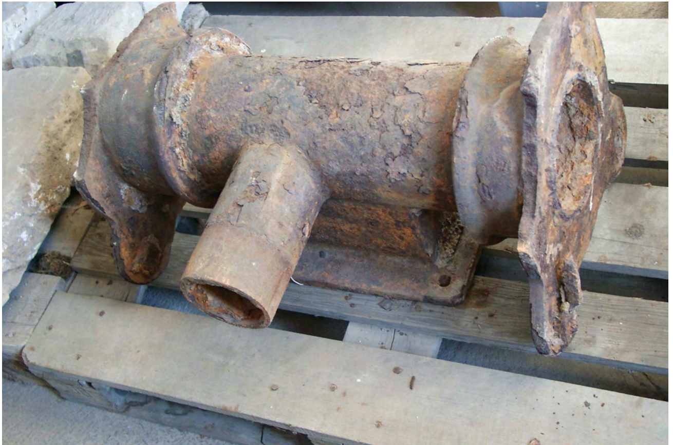
Abb. 4: Gusseisernes Zwischenstück einer Sandstein-Wasserleitung
