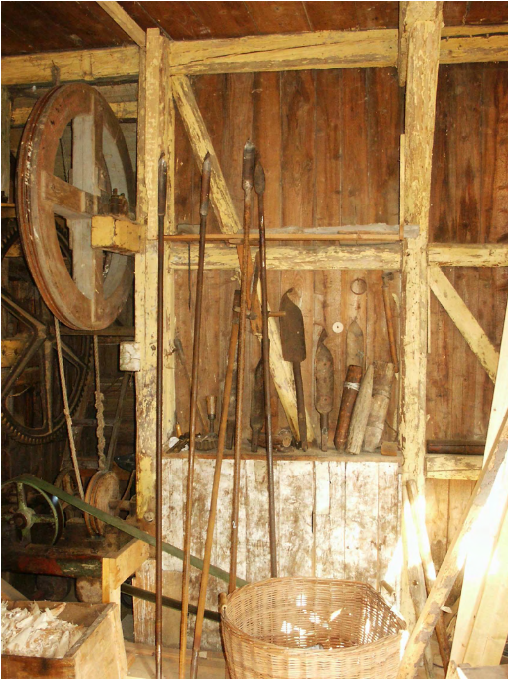
Abb. 3: Verschiedene Bohrer und elektromechanischer Antrieb des Bohrwerks
