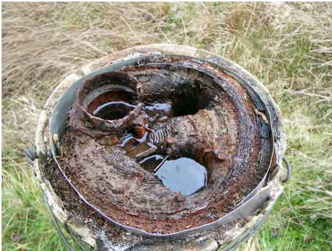
Bild 2: Wasserverteilung im Ständer- Beispiel aus dem Erzgebirge (Foto: WIMA/D e.V.)
