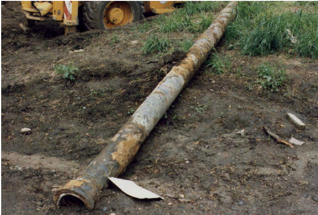
Abb.4: Gusseiserne Röhrfahrt der Oberfischmannsteichleitung im 20. Jahrhundert
