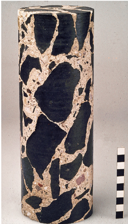
Bild 7: Der Bohrkern aus der ältesten Kölner Römerleitung von 30 n. Chr. zeigt die enorme Qualität des Opus caementicium und eine sehr hohe Druckfestigkeit.
