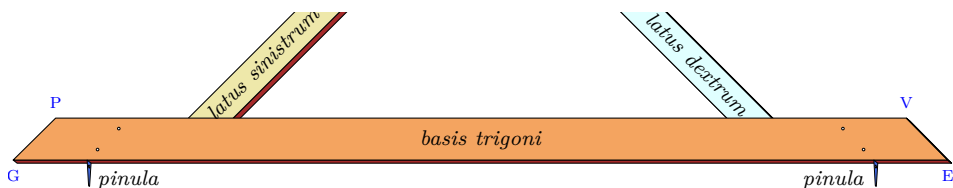
Fig. 9 – 11, 6, 4r: Absehen ( pinule ) auf der unteren Schmalseite der Basis im Abstand von fünf Fuß. Auf den Zusätzen ergänzend eingezeichnet sind die Löcher, durch die die Nägel der Abstandhalter des Doppeldreiecks gehen. Text S. 40.
